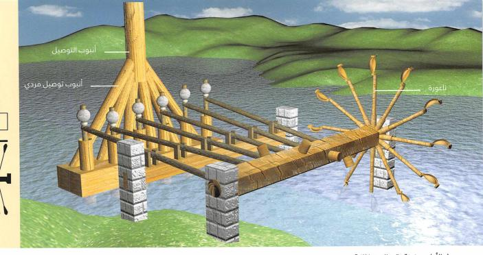
في الأعلى: مضخة تقي الدين المائية، سداسية الأسطوانات. لاحظ كيف يتحكم محور الحدبات (Camshaft) بحركة القضبان الرابطة لتوليد حركة متجانسة للمكابس الستة بحيث يُرفع الماء باستمرار.
